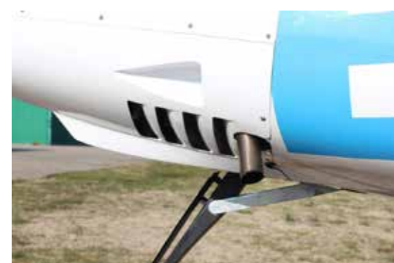
Il corto tubo di scarico è posto dietro le feritoie di estrazione dell'aria di raffreddamento
